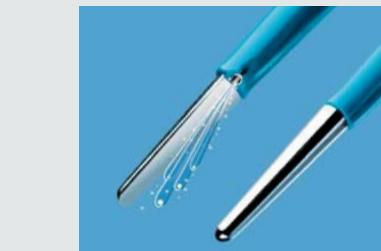
Pinzetten mit integrierter Spülung sind besonders geeignet zur Koagulation von Gewebe, bei dem es zu starkem Verkleben mit der Pinzettenspitze kommen kann (z. B. bei Lebergewebe oder in der Neurochirurgie). Die NaCl-Spülösung führt zu verbesserten elektrischen Kontakt und reduziert damit das Anhaften des Gewebes und die Notwendigkeit der intraoperativen Reinigung des Instruments.
